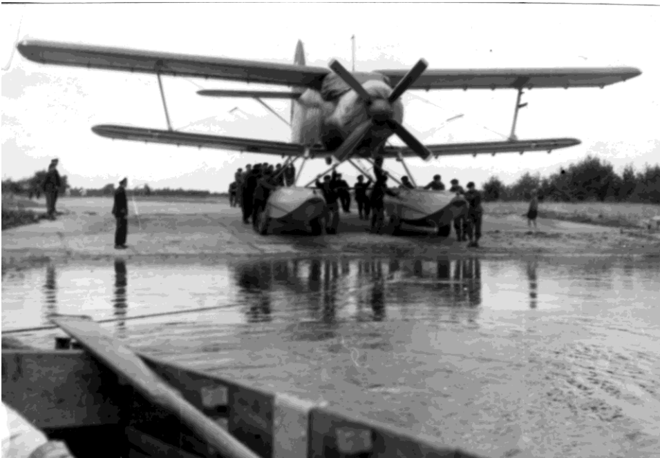
Slipowanie samolotu An-2 wyposażonego w pływak.
