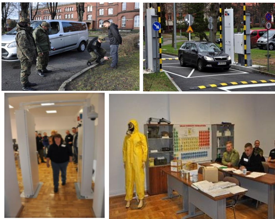
Fot. 25, 26, 27, 28. Bramki radiometryczne, w które wyposażony został Ośrodek w ramach programu pomocowego „Second Line of Defense” przez Departament Energii Stanów Zjednoczonych Ameryki – ze zbiorów COSSG
